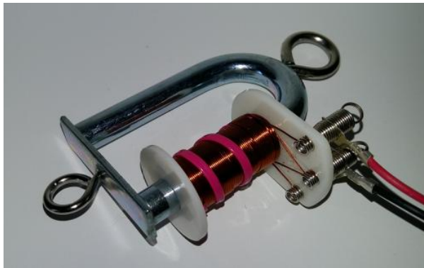
Spolen montert på U-kjernen med ledninger tilkople
