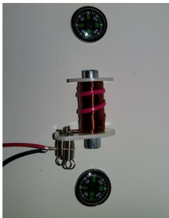
Kompass plassert i hver ende av kjernen viser magnetfeltets retning
