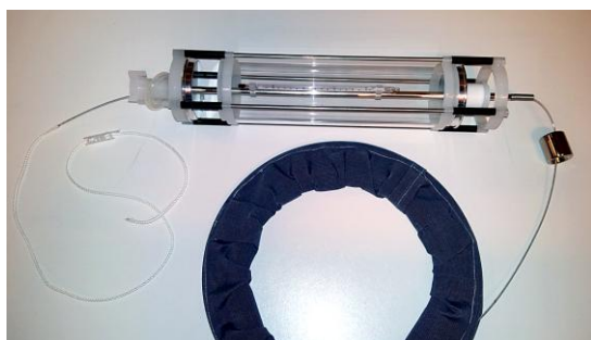
Figur 2 Wiren tres gjennom vannhenteren
